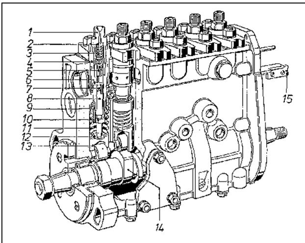
Fig. 3.11: Diesel injector pump (Bosch).
